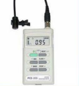
**SONÓMETROS:** Instrumentos para medir el nivel de presión acústica de los ruidos ambientales.
